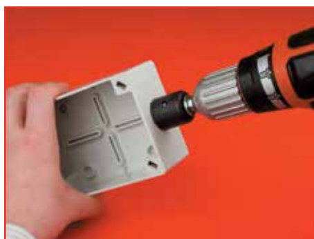
Сверлим отверстия необходимого диаметра
